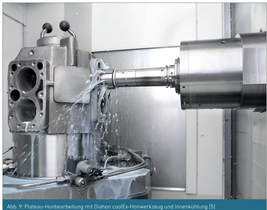
Abb. 9: Plateau-Honbearbeitung mit Diahon coolEx-Honwerkzeug und Innenkühlung [5]
