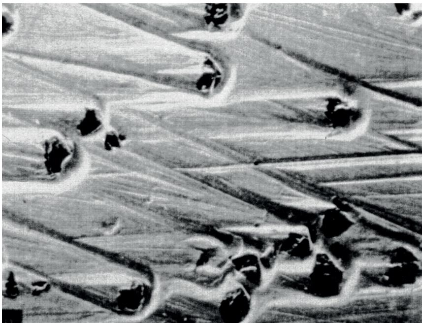
Abb. 3: Ausschnitt einer CBN-Honleistenschneidfläche in eingelaufenem Zustand [2]
